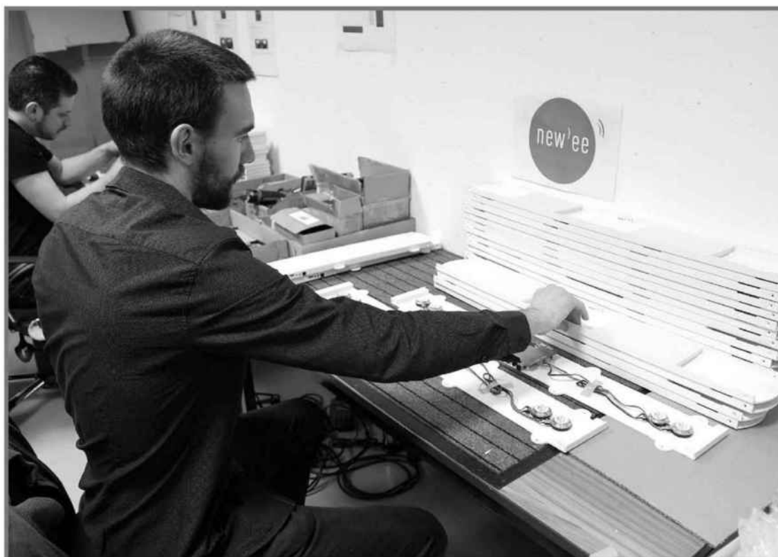
Assemblage de bandeaux sonores dotés de mini-moteurs vibrants qui pourront être fixés à une tête de lit.
